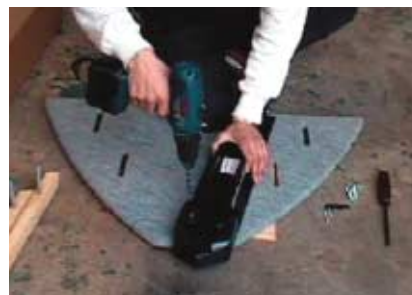
マウントの装着位置を決めたら、ドリルでネジ穴を開け、ボルトとナットで固定します。
