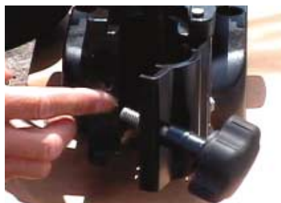
ブラケットのネジ山部分をグリスアップし、馴染ませます。
