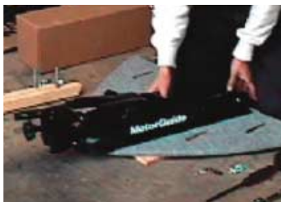
パワードッキにマウントを取り付けます。船首中央にエレキ本体のシャフトがセットできるように合わせます。この時マウントの後ろを左右どちらかに振ります。
