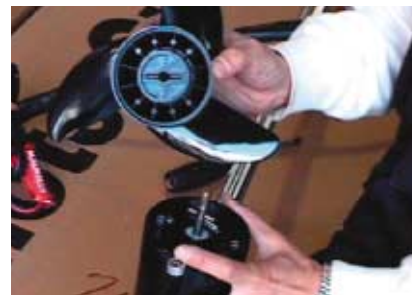
プロップをエレキ本体に取り付けます。プロップピンがセンターにくるようにセットします。
